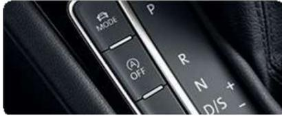
La selección del perfil de conducción posibilita un ajuste individual del volante (modo normal y sport), de la línea característica del motor y de la transmisión así como de su ajuste permanente automático a la situación e conducción. Pulsando en botón, podrá elegir entre las cinco configuraciones "NORMAL", "ECO", "SPORT", "COMFORT" e "INDIVIDUAL".
